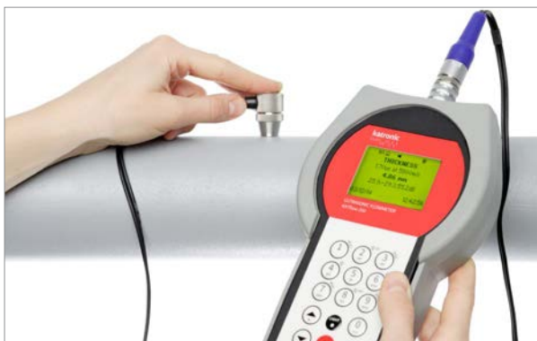
Wanddickensensor NT und KATflow 200 im Einsatz
